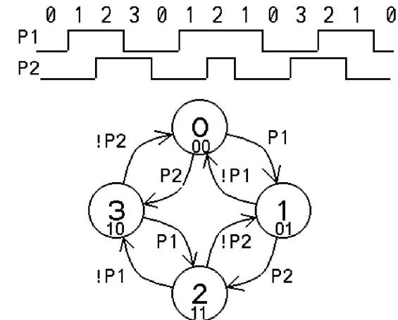
La période d'échantillonnage doit être inférieure au temps minimum entre 2 transitions.
