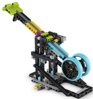
Avant le match, vous sélectionnez manuellement le réglage du levier de la machine. Pendant le match, le robot déplace le levier jusqu'à ce que la petite butée jaune tombe.
