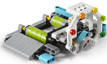
Le robot fait tourner les rouleaux pour déplacer le pointeur aussi loin que possible dans le sens horaire.
