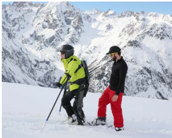
L'exosquelette Wiite permet à une personne atteinte d'une lésion complète de la moelle épinière de faire de la randonnée à ski de manière autonome.
