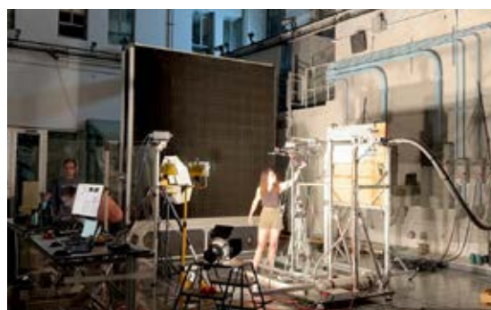
Malicia Leipold, doctorante HEPIA-EPFL, teste un prototype à échelle réduite du Mars Science Helicopter du JPL de la NASA devant une soufflerie windshaper (photo © NASA JPL).
