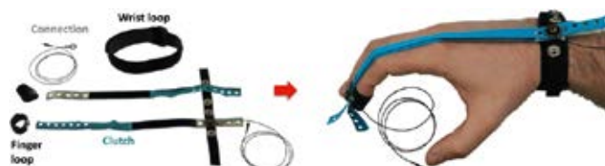
Embrayages ou freins électrostatiques à haute force en textiles minces.
