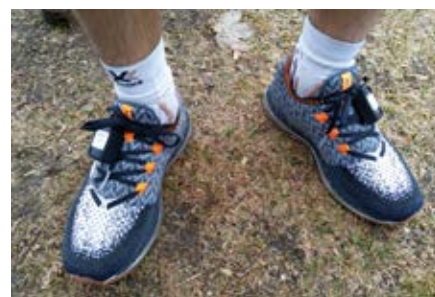
Unités de mesure inertielle portées au pied (Physilog 5).
