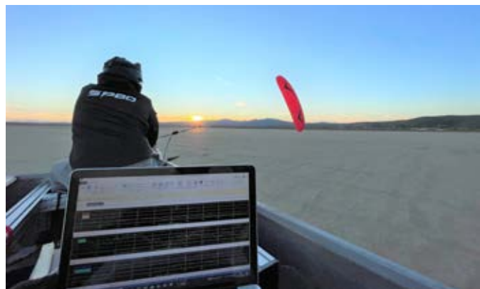
Essai aérodynamique de kite avec balance de mesure de force (photo © SP80).
