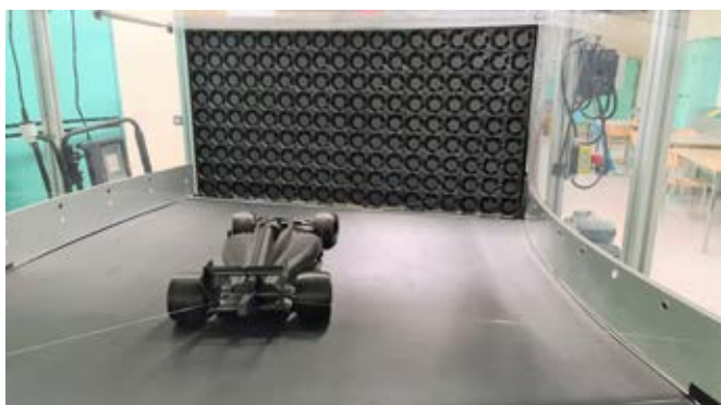
Aérodynamique en virage dans une soufflerie windshaper avec tapis roulant circulaire, photo © Flavio Noca.
