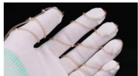
Prototype intégrant la pompe à un gant.
