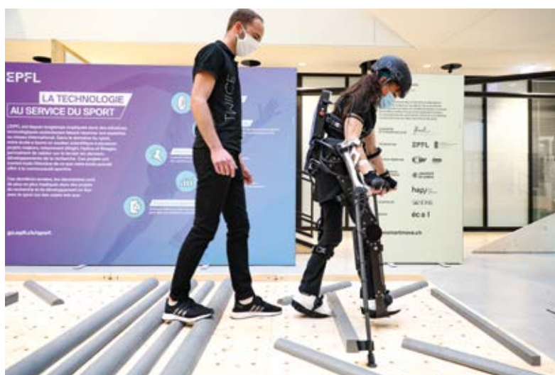
L'exosquelette Twice One permet à une personne atteinte de paraplégié complète de retrouver le monde vertical et la capacité de marcher, grâce à des moteurs aux articulations.
