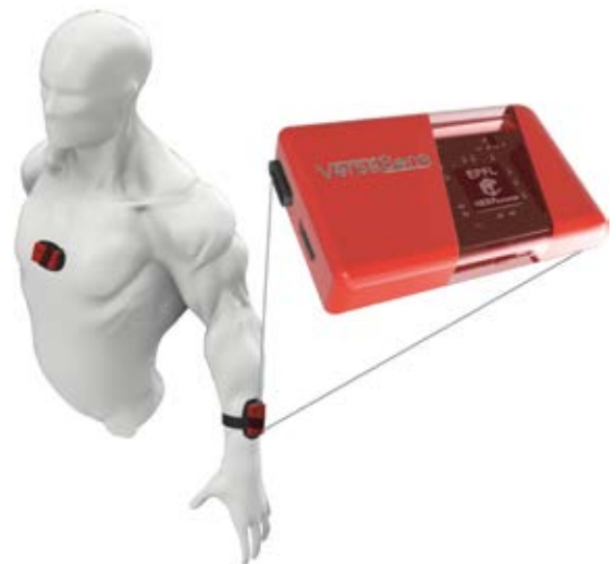
VersaSens est un dispositif portable de surveillance multimodale des biosignaux (par exemple, cinématique, ECG, PPG) qui peut être utilisé pendant les activités sportives et quotidiennes.
