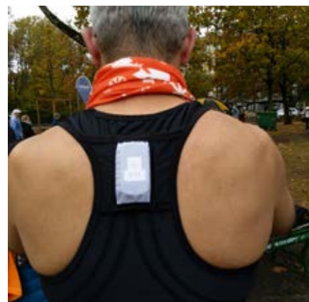
Unité de mesure inertielle, capteur ECG et GPS (Fieldwiz) portés dans le dos.
