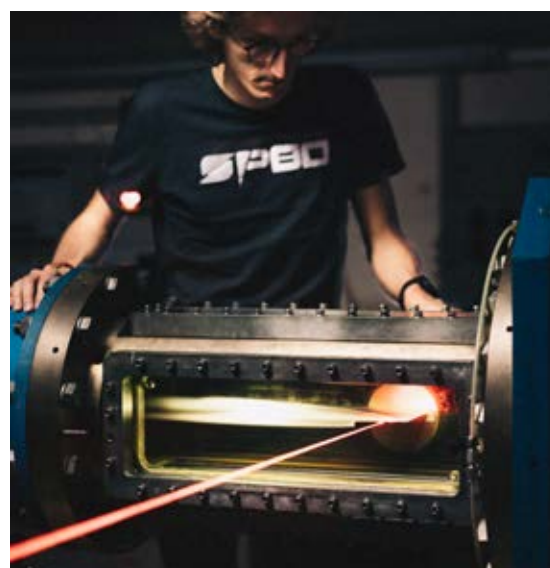
Essais d'ailerons au tunnel de cavitation du LMH - © Guillaume Fischer.
