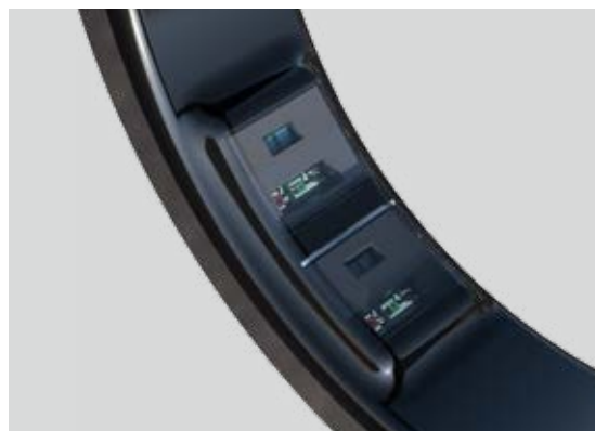
Intégration des puces PPG les plus petites au monde permettant d'intégrer dix-huit sources lumineuses et six capteurs sur le pourtour de la bague.
