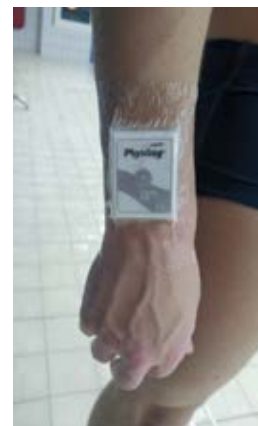
Capteur de mesure inertielle fixé sur le poignet.
