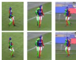
La méthode utilisée par le CVLAB permet de recomposer de façon fiable la posture du joueur en 3D avec une seule caméra.
