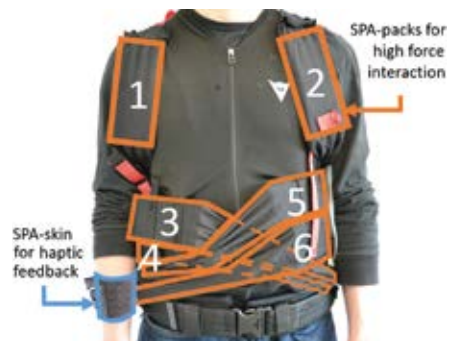
Un exocostume robotique complètement flexible avec deux types d'actionnement pour un retour tactile et un maintien de la posture avec une force de sortie pouvant atteindre 100 N par élément (orange).
