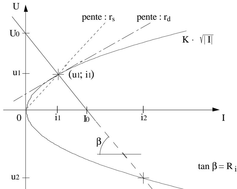
On détermine maintenant le point de fonctionnement analytiquement :
