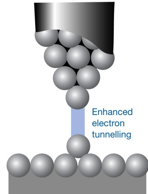
**Microscope à balayage à effet tunnel**
